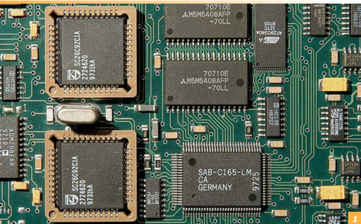
Board 2 heeft zes keer meer functionaliteit per cm 2 boardoppervlak dan board 1.
