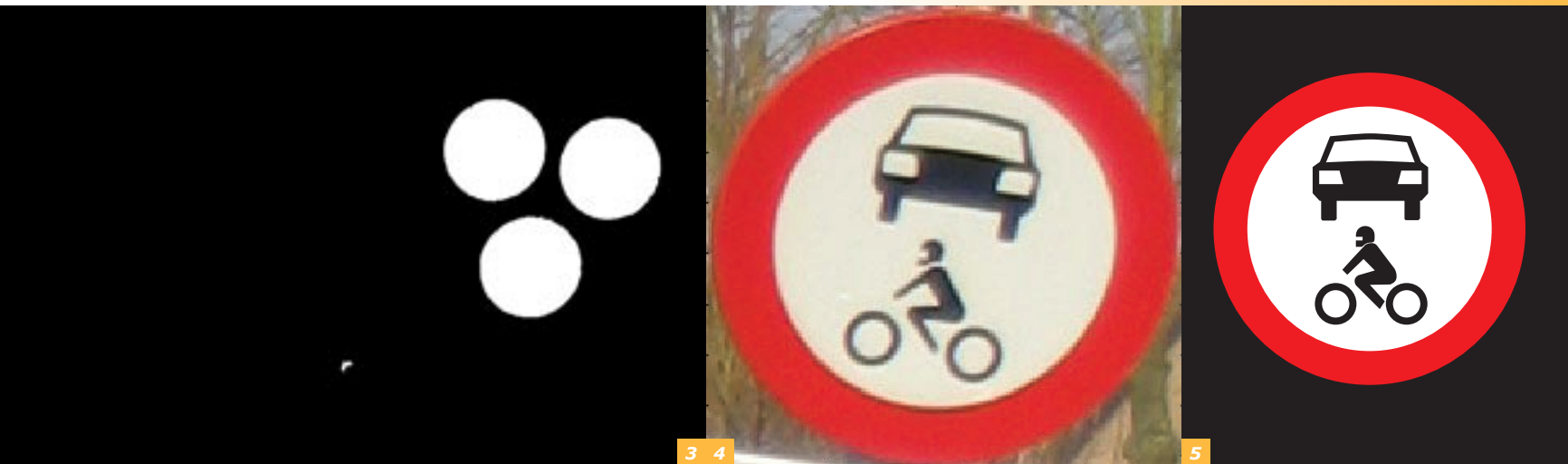
3. Alle gesloten vormen worden ingevuld zodat een masker ontstaat. 4. Er wordt vervolgens een uitsnede van het oorspronkelijke beeld gemaakt voor het herkennen van het verkeersbord. 5. Tenslotte wordt er automatisch een vergelijking gemaakt met een referentiebeeld om het verkeersbord te herkennen. Dit beeld met hetzelfde verkeersbord levert de hoogste score op, waarmee het beeld is herkend.
