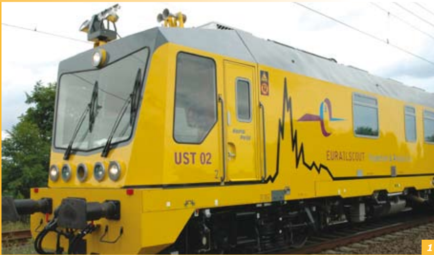
1. Spoorrailtesttrein. 2. Meetspecialist, Michiel Tempelmansplat, voert gegevens in op de handheld.
