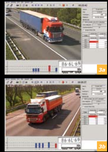
1. Verkeersbord. 2. Weigh In Motion systeemarchitectuur. 3. Gebruikersinterface voor correctieve handhaving. 3a Overbelading op rechter rijstrook. 3b Overbelading op 1e inhaalstrook.
